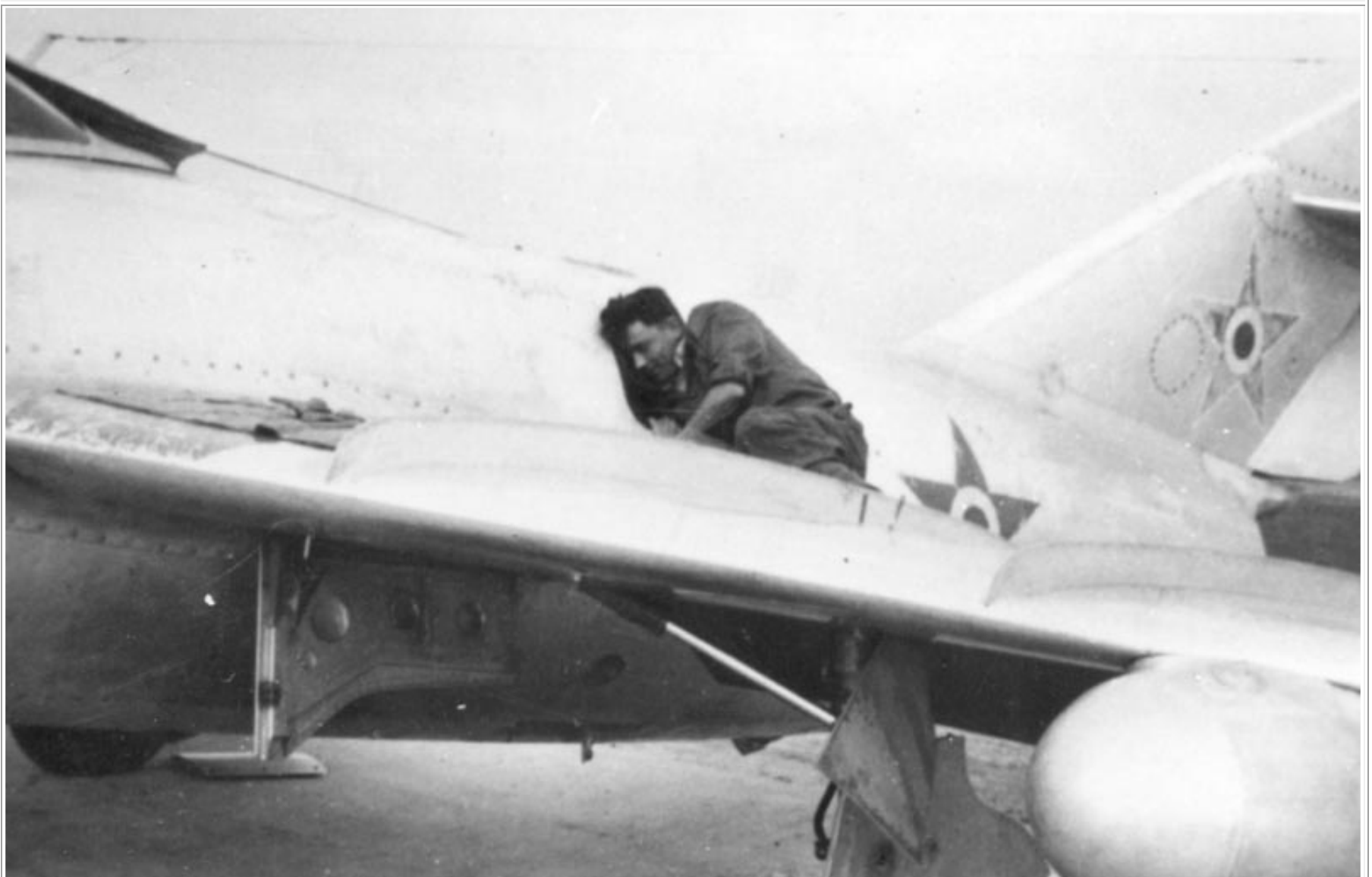
A fékszárny helyzetét jelző katona egyébként nem csak a kivágott lemezes gépeken volt megtalálható, hanem azokon is, amelyeken nem volt kivágva a lemez. Nagy András fenti fényképén a futó és a fékszárny helyzetjelző katonái egyaránt kinti helyzetben láthatók, miközben az áramlásterelő lemez sincsen kivágva.
