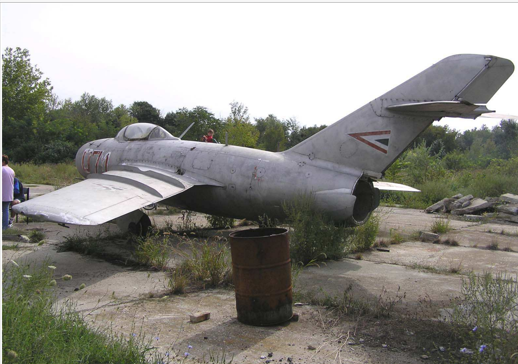
A 071-es bisz a Börgöndi repülőtéren, egy már kivágott lemezes bal szárnyal felszerelve. Valószínűleg kicserélték a szárnyat egy javítás vagy nagyjavítás során.
