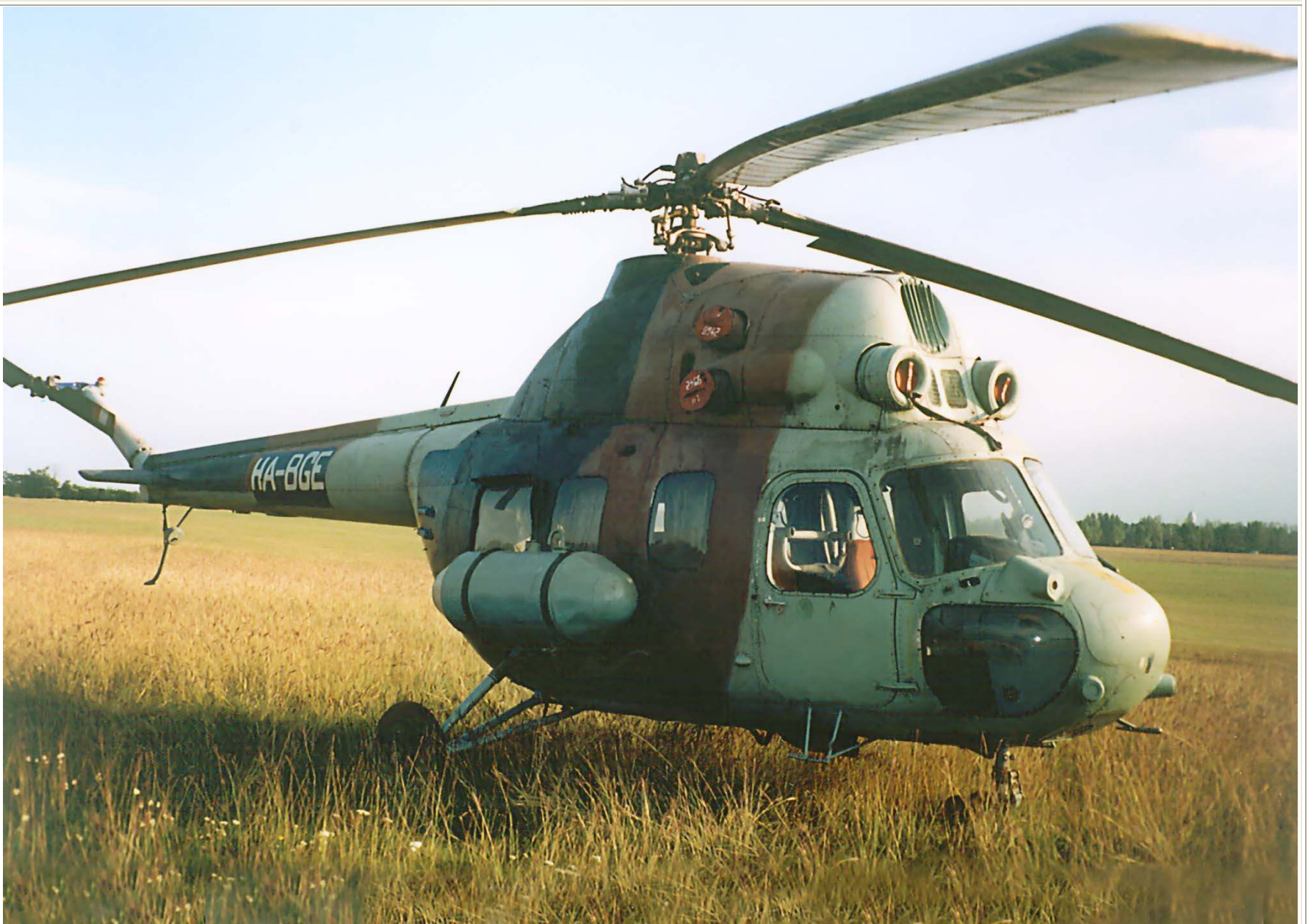
A helikopter jobb oldala közelről, némi ellenfényben, Dunakeszin, 1999. szeptember 23-án délután. A gép orr-részének a felső részén, a jobb oldali ablak előtt egy henger alakú szerkezet látható, amely a fegyveres változatú Mi-2-es helikopterek sajátossága, függetlenül attól, hogy milyen fegyverzettel szerelték fel az adott gépet. Ennek a feladatát nem ismerem, elképzelhető, hogy ez a tárgy valamilyen fegyver vagy célzó berendezés rögzítési lehetőségét adta.
